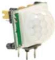
1. Rajoute la brique de détecteur de mouvement sur la platine.
