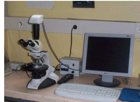
Microscope polarisé avec platine chauffante et caméra numérique - Leica
