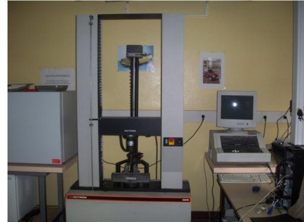
2 Machines de Traction Instron de 5 – 10 – 100 KN
